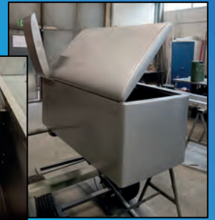
Sisäpuolelle laitettiin harmaa panssarimaali
